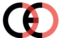
Falsk CE-mærke (for tæt på hinanden)
